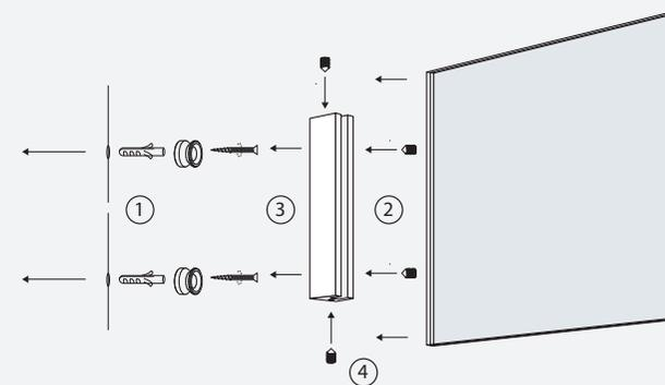
Das Fahnschild besteht aus zwei ESG-Scheiben und einem Fahnenadapter. Die beiden Wandhalter des Adapters werden mit jeweils einer Schraube\* befestigt (1). Der Wandadapter mit den darin befestigten Scheiben (2) wird aufgesteckt (3) und mittels Mutterschrauben fixiert (4).
